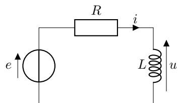
où  $e(t)$  est un échelon de tension de hauteur  $E$  à  $t = t_0$ , c'est-à-dire :
