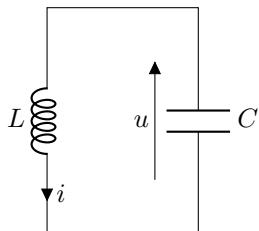
Le courant  $i$  est le courant qui traverse la bobine mais également le condensateur, la tension  $u$  est la tension aux bornes du condensateur mais également de la bobine.
