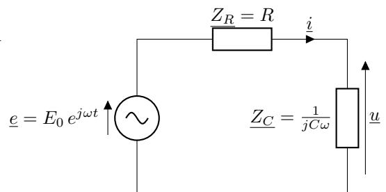
L'équation différentielle s'obtient en repassant en réel et en interprétant les termes en  $j\omega$  par  $\frac{d}{dt}$  (et donc  $-\omega^2 = (j\omega)^2$  par  $\frac{d^2}{dt^2}$  pour des circuits d'ordre 2) :
