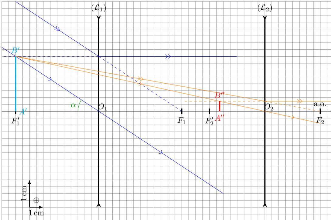
6. On passe par l'image intermédiaire  $A'B'$  on a  $AB \xrightarrow{\mathcal{L}_1} A'B' \xrightarrow{\mathcal{L}_2} A''B''$ . L'objet  $AB$  étant à l'infini, on a  $A' \equiv F'_1$ . On note  $\Delta = \overline{O_1 O_2}$ .
