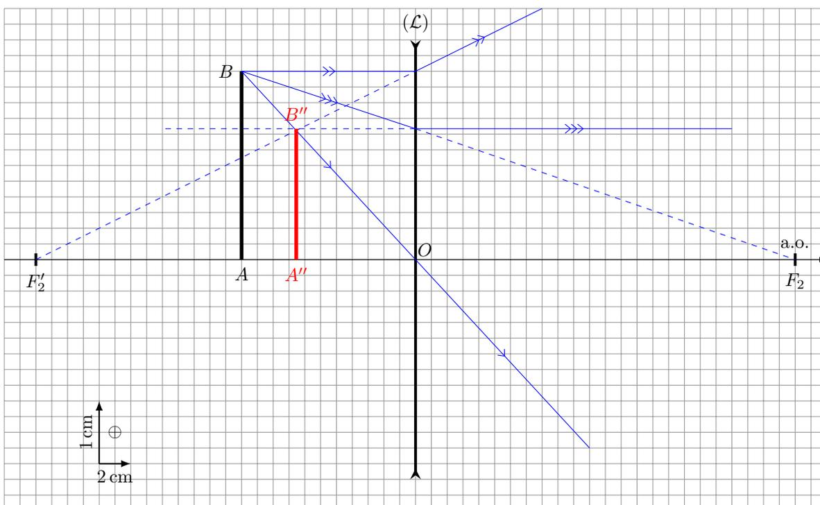
On lit directement sur le graphique, en tenant compte de l'échelle et du sens positif des grandeurs algébriques  $\overline{OA''} = -7,6 \text{ cm}$  et  $\overline{A''B''} = 2,1 \text{ cm}$
