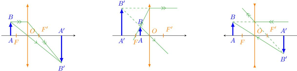
Les positions relatives de  $F$  et  $F'$  par rapport au sens initial de la lumière permettent de déterminer la nature des lentilles : convergente pour les deux schémas de gauche, divergente pour celui de droite.
