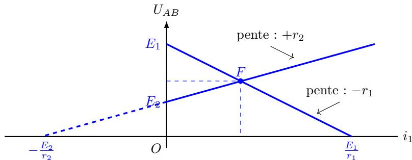
(c) Au point d'intersection (F)  $E_1 - r_1 i_1 = E_2 + r_2 i_1$ , d'où  $i_1 = \frac{E_1 - E_2}{r_1 + r_2}$
