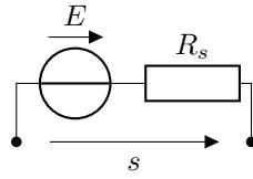
2. Le circuit est maintenant fermé par la résistance  $R$ . On reconnaît un pont diviseur de tension, on peut ainsi écrire
